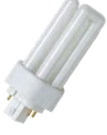
Excelente a moderada reprodução de cores, boa eficiência luminosa, vida mediana de 7.500 a 20.000 horas, exige equipamento auxiliar (reator).          | 70 lm/W             |
